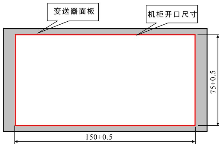
安装前请先将外壳两侧的顶杆拆下, 然后将仪表由前面装入机柜中, 将两只顶杆固定在仪表两侧, 要求顶紧仪表外壳以保证牢固安装。机柜深度不小于180mm, 方便接线。
