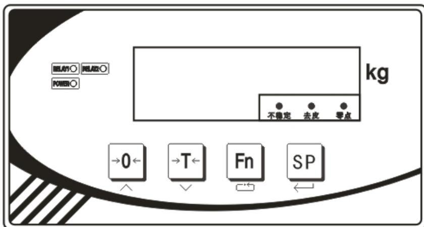
称重显示控制器显示面板上布置了四个按键，用于仪表的各种操作及参数设定。
